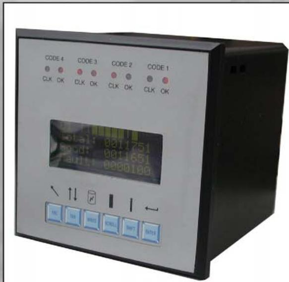
L'interfaccia uomo macchina al quanto intuitiva messa a disposizione dell'operatore presenta tutte le funzioni per la visualizzazione e il monitoraggio contemporaneo di più codici. Le molteplici funzionalità e opzioni presenti nel software permettono un'ottimizzazione della lettura del codice in tutte le situazioni.
